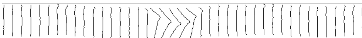
Przykład 9: Manewr omijania pojazdu stojącego na poboczu widoczny na wizualizacji równości poprzecznej na profilu liniowym
