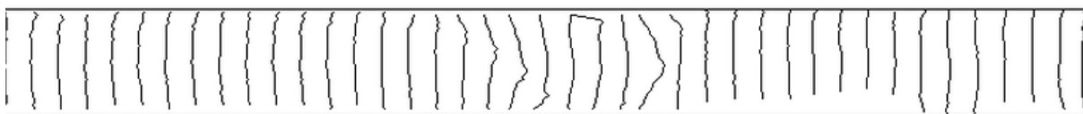
Przykład 11: Manewr wyprzedzania pojazdu widoczny na wizualizacji równości poprzecznej na profilu liniowym
